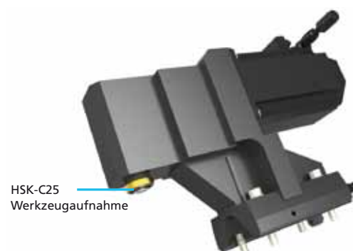
GWS-Axial Bohr- und Fräseinheit i=1:2 ; max. 8.0001/min – 4,4Nm
