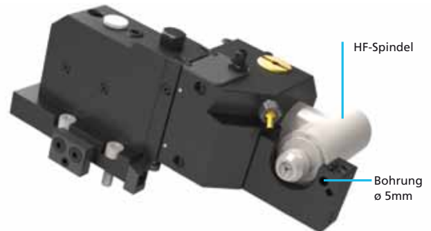
GWS-Werkzeughalter für Gegenspindelbearbeitung für Winkel-HF-Spindel (ø 25 oder 30mm) und Aufnahme für 1 Werkzeug mit Schaft- ø 5mm
